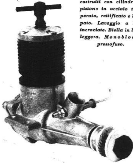
G. 27 - Cilindrata 3,28 cc. Corsa mm. 15. Alesaggio mm 16,5. Peso gr. 175. Tipo diesel. Potenza 0.35 HP a 13.000 giri. Prezzo L. 6.500
