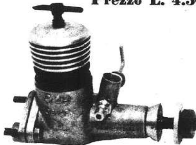
G. 29 - Cilindrata 0,8 cc. Corsa mm. 8,5. Alesaggio mm. 11,1. Peso gr. 43. Tipo diesel e tipo glow-plug. Regime di rotazione 14.000 giri con elica 15,5x7,5. Prezzo L. 4.200
