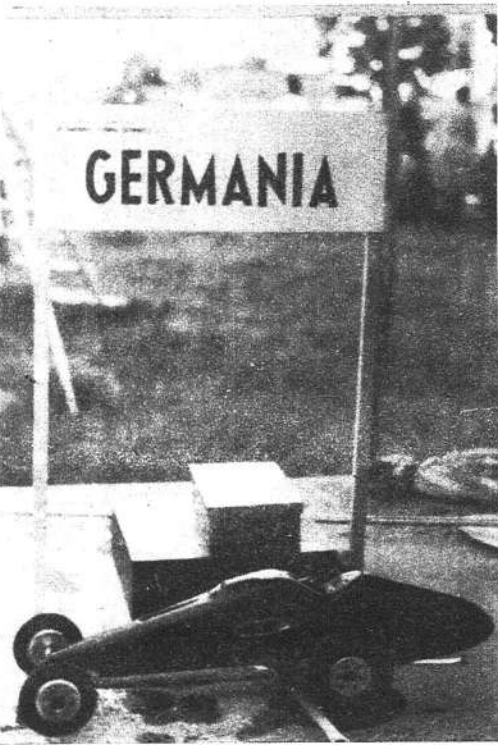
In alto: il gruppo dei concorrenti. Sopra a sinistra: lo svedese Zetterstrom ha dominato la classe 10 cc. con questa Fox munita di Dooling 61 a volano magnete. A destra: la macchina del tedesco Lallinger, seconda classificata nella classe 5 cc.; motore Dooling 29 e carrozzeria in fiberglass
