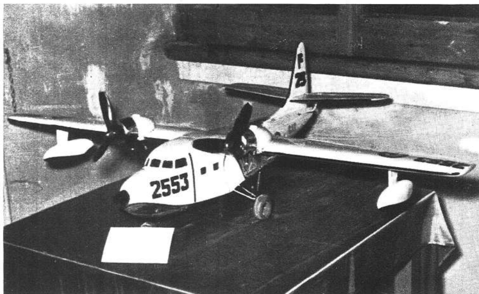
Una magnifica riproduzione del bimotore anfibia Grumman S.A. 16 Albatross, opera del Ten. Col. Alfredo Francione di Taranto. I motori sono due G 21; il carrello può essere retratto ed il modello può decollare dall'acqua. Esso troneggia in una esposizione organizzata dall'Aero Club di Taranto presso la IV Mostra dell'Artigianato.
