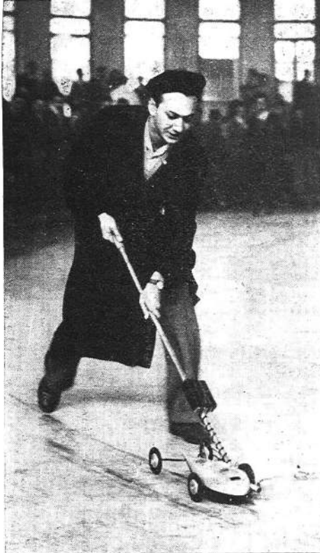
Al Palazzo del Ghiaccio, per la prima volta, abbiamo assistito a qualche partenza con l'asta. Nella foto Fanoli sta spingendo la sua «rana» (si noti, sull'asta, il gruppo delle batterie per l'accensione della «glow»).
