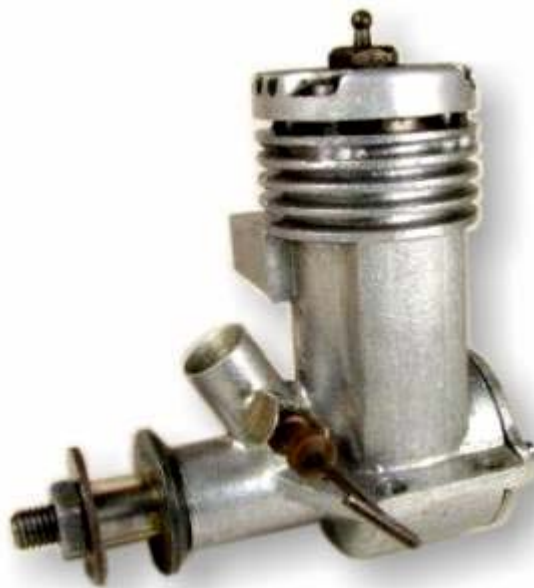
Uno dei primi Fox 35 del 1948, con 4 viti alla testata e 2 al tappo carter
