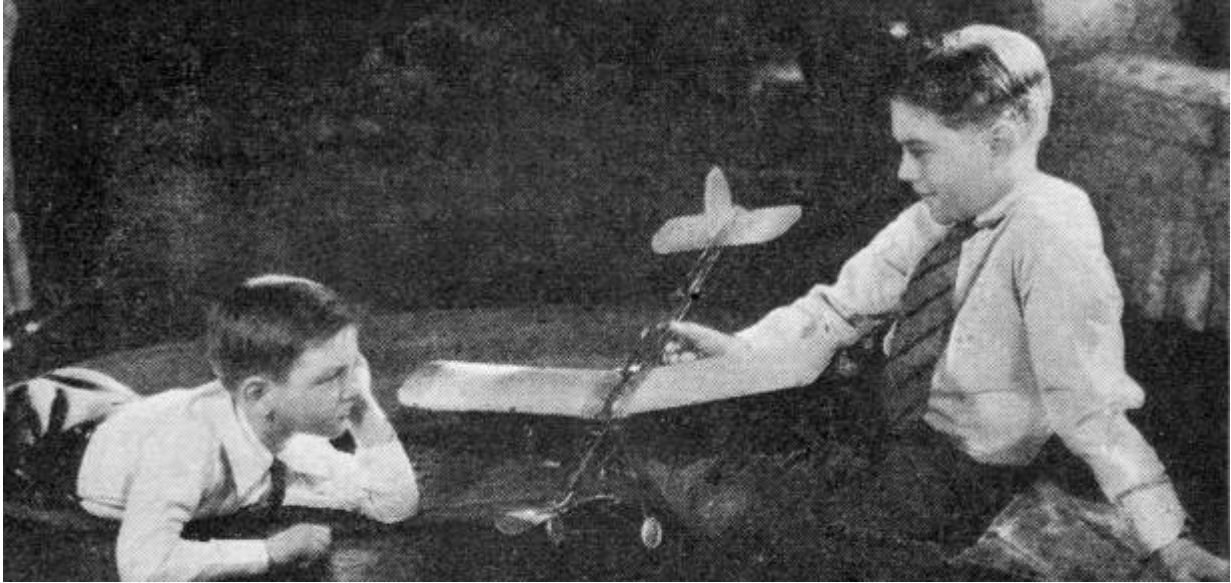
Questo è quello che all'epoca si intendeva per "Baby ROG": un modello a elastico con fusoliera a trave e carrello per il decollo da terra.
