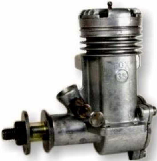
1952: le viti della testata passano da quattro a sei, e compaiono il classico venturi a tromboncino e il marchio Fox 35.
