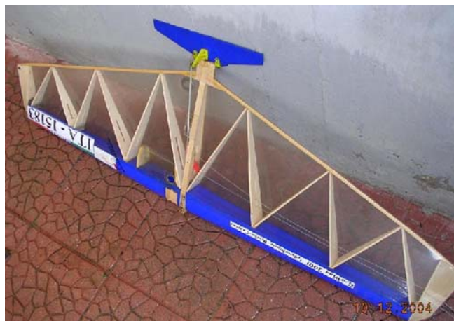
Fig. 8- Il Geowind 2001 a struttura geodetica di Orazio Motta, sei centine per semiala, portato in gara all'Europeo 2001 a Valladolid (SPAGNA).
