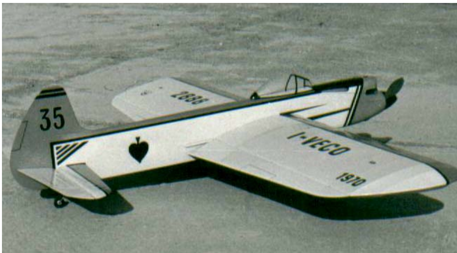
Sopra: L'acrobatico MAPI, un interessante progetto personale di IVO BRAGADIN del 1957. Purtroppo la qualità di stampa non rende giustizia alle preziose rifiniture sul muso e nella carenatura motore. Il modello montava un G 21 e veniva fatto volare con cavi da 18 metri.
